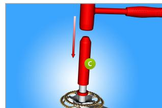
Per installare il cuscinetto sulla pedivella, si utilizza lo strumento di installazione pedivella (C) con un martello.
