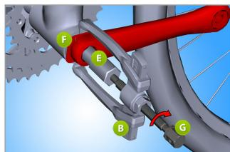
Per la rimozione della pedivella in alluminio Campagnolo ® Ultra Torque utilizzare la sottile piastra di protezione(F) che si trova tra la pedivella e la calotta.
