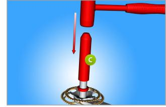
Zur Montage des Lagers verwenden sie das Montagewerkzeug (C) und einen Hammer.
