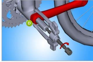
Zur Demontage von Campagnolo® Power Torque Karbonkurbel wird der Vorgang aus dem vorherigen Schritt mit der Aluminiumkurbel wiederholt, es wird hierbei nur eine dickere Schutzscheibe (D) verwendet.
