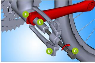
Zur Demontage von Campagnolo® Ultra Torque Aluminiumkurbeln verwenden Sie die dünne Schutzscheibe (F), die Sie zwischen die Kurbeln und die Tretlagerschale einsetzen. Setzen Sie nach der Demontage der Schraube die Metallverlängerung (E) in die Kurbel, diese entfernen Sie danach mit Hilfe eines universellen Abziehers durch Drehen der Spindel mithilfe eines Schlüssels Dim. 19 mm im Uhrzeigersinn.
