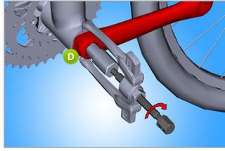
Para remover la manivela de carbono Campagnolo® Ultra Torque, se utiliza el mismo procedimiento que con la manivela de aluminio, excepto que debemos utilizar el protector plástico más grueso (D).
