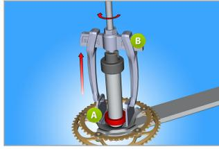
Para remover el cojinete de la manivela, utilizamos el extractor universal (B) junto con la extensión para remoción de cojinetes (A).
