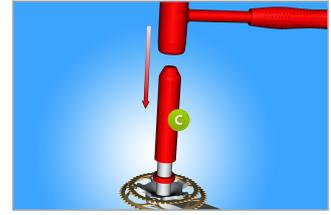
Para instalar el cojinete en la manivela, utilizamos la herramienta de instalación universal (C) junto con un martillo.
