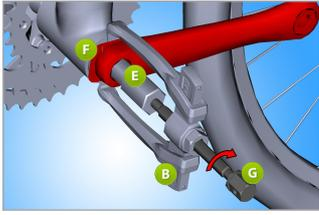
Para remover la manivela de aluminio Campagnolo® Ultra Torque, usamos el delgado plato protector (F) el cual lo instalamos firmemente entre la manivela y el eje del pedalier. Luego insertamos la extensión del clavo (E) en el fondo de la taza y con el uso
