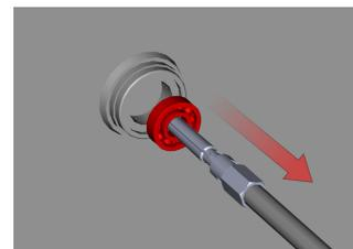
Po nekaj kratkih udarcih hitro in enostavno izbijemo ležaj iz ohišja brez poškodb.
