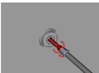
Prvo postavite izvlakač kroz otvor ležaja koji treba demontirati s kućišta. Zatim počnete zavijati trn, koji ima funkciju da otvoriti tijelo izvlakača tako da se prilagodi veličini otvora ležaja.
