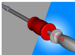
Pomoću čekića, jednakomjernim udarcima, počnete izbjijati ležaj iz kućišta.
