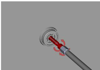
Introduire l'extracteur dans le trou central du roulement à retirer. Ensuite, commencer à visser pour que les bras de l'extracteur s'écartent, se bloquant ainsi dans le trou central du roulement.
