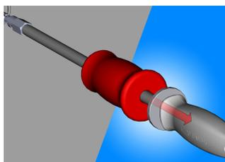
Schlagen Sie das Lager mit einigen Schlägen mit dem Schlaghammer aus dem Gehäuse.
