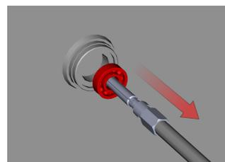
Das Lager wird nach einigen Schlägen schnell und einfach ohne Beschädigungen aus dem Gehäuse geschlagen.
