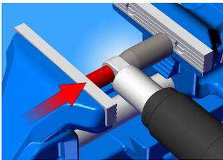
alat se postavi zajedno sa amortizerom u stegu i jednakomernim stezanjem stege čaura se sitisne iz amortizera. Na taj način, čaura se zapravo pomeri u širi deo alata, odakle se jednostavno izvadi.
