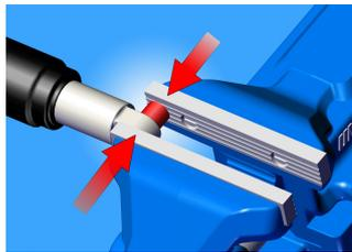
Новая втулка располагается параллельно, рядом с отверстием на амортизаторе, и помещается в тиски вместе с ним. С помощью тисков втулка запрессовывается в амортизатор.
