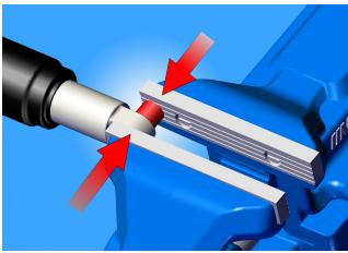
Nova čahura postavlja se paralelno s otvorom amortizera i zajedno se postavljaju u stegu. Jednakojernim pritiskanjem stege čahura se postavlja u kućište amortizera.
