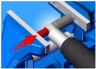
Alat se postavi zajedno s amortizerom u stegu i jednakojernim stezanjem stege čahura se istisne iz amortizera. Na taj način, čahura se zapravo pomakne u širi dio alata, odakle se jednostavno izvadi.
