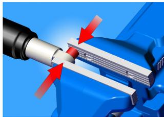
Stellen Sie die neue Lagerbüchse parallel zu der Öffnung am Stoßdämpfergehäuse und spannen Sie das Ganze in einen Schraubstock. Drücken Sie danach die Lagerbüchse durch gleichmäßiges Spannen vollkommen in das Stoßdämpfergehäuse hinein.
