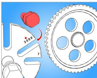
krake izvlakača (3 kraka) postavljate u otvore remenice u skladu sa brojem otvora na remenici. Npr.: ukoliko remenica ima 5 otvora, tri kraka postavljate u otvore izvlakača koji su obeleženi brojem 5
