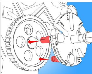
postavite krake izvlakača u otvore remenice
