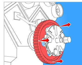
Una volta finito di lavorare, rimuovere l'estrattore.
