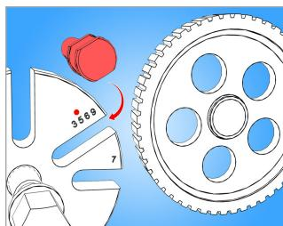
Inserire le gambe dell'estrattore (3x) nelle scanalature della puleggia in accordo col numero delle fessure.
