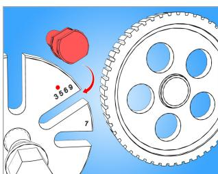
Krake izvlakača (3 kraka) postavljate u otvore remenice u skladu s brojem otvora na remenicu. Npr.: ukoliko remenica ima 5 otvora, tri kraka postavljate u otvore izvlakača koji su obilježeni brojem 5
