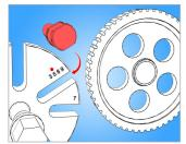
Insérer les bras (3x) de l'extracteur dans les encoches de l'extracteur correspondant au nombre de trous dans la poulie. Par exemple, si la poulie possède 5 trous, insérer les trois bras dans les trois encoches identifiées par le numéro 5.
