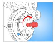
Tourner l'arbre dans le sens des aiguilles d'une montre jusqu'à la libération de la poulie.
