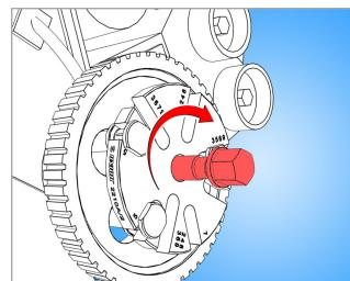
tourner l'arbre dans le sens des aiguilles d'une montre jusqu'à la libération de la poulie.
