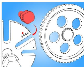
Insérer les bras (3x) de l'extracteur dans les encoches de l'extracteur correspondant au nombre de trous dans la poulie. Par exemple, si la poulie possède 5 trous, insérer les trois bras dans les trois encoches identifiées par le numéro 5.
