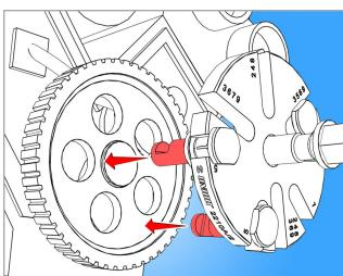
Postavite krake izvlakača u otvore remenice
