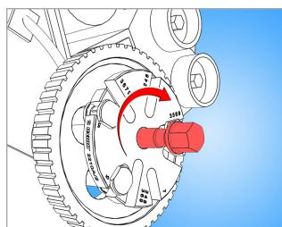
Za pričvršćivanje izvlakača na remenicu okrećite vreteno u smjeru kazaljke na satu dok se izvlakač ne pričvrsti
