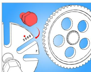
Krake izvlakača (3 kraka) postavljate u otvore remenice u skladu s brojem otvora na remenici. Npr.: ukoliko remenica ima 5 otvora, tri kraka postavljate u otvore izvlakača koji su obilježeni brojem 5
