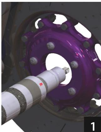
Установите ударную отвертку на головку винта, который мы будем затягивать (R) или ослаблять (L).
