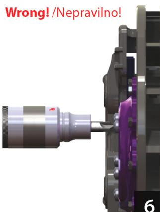
Когда инструмент находится в сжатом положении, и мы ударяем по нему молотком, внутренний механизм разрушается. Никогда не ударяйте по инструменту молотком, когда инструмент находится в сжатом положении!
