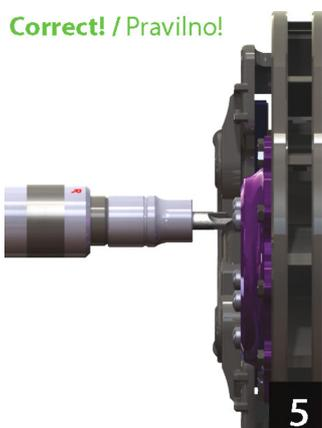
Установите инструмент на головку винта и не сжимайте его до предельного положения перед использованием. При ударе молотком инструмент автоматически срабатывает и начинается затягивание/ослабление.
