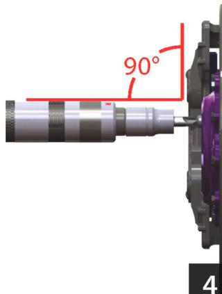
При затягивании или ослаблении винта инструмент должен располагаться перпендикулярно винту!
