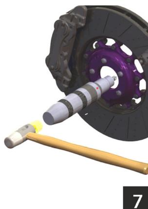
Когда инструмент правильно расположен на винте, с помощью молотка мы лишь слегка ударяем по держателю инструмента, тем самым приводя в действие механизм, который позволяет нам повернуть винт приблизительно на 15°.
