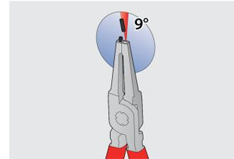
Le punte sono inseriti nella ganaschia all'angolo che impedisce all'anello elastico di scivolare
