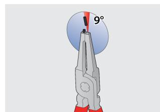
Die Spitzen werden in die Klemmbanke mit einem Winkel eingesteckt, der verhindert, dass der Sicherungsring von den Spitzen gleitet.
