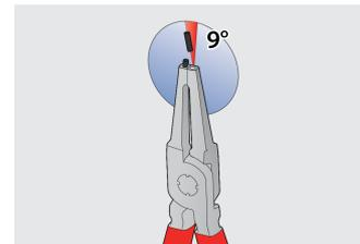
Les pointes des mâchoires sont orientées à un angle de 9° pour donner un maximum de prise sur le circlip et empêcher tout glissement.
