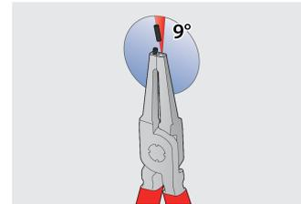
Las puntas se insertan en la mandíbula en un ángulo que impide que la arandela se deslice fuera de las puntas.
