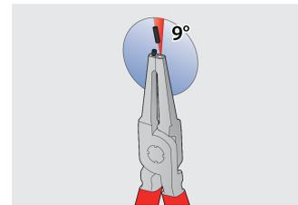
Die Spitzen werden in die Klemmbanke mit einem Winkel eingesteckt, der verhindert, dass der Sicherungsring von den Spitzen gleitet.
