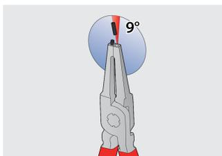
Le punte sono inseriti nella ganascia all'angolo che impedisce all'anello elastico di scivolare
