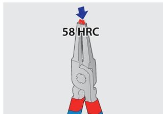
Bis zu 58 HRC gehärtete Spitzen verhindern das Verbiegen oder Brechen der Spitzen bei der Montage oder Demontage von Sicherungsringen
