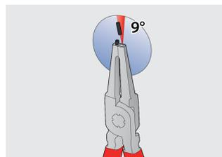
Las puntas se insertan en la mandíbula en un ángulo que impide que la arandela se deslice fuera de las puntas.
