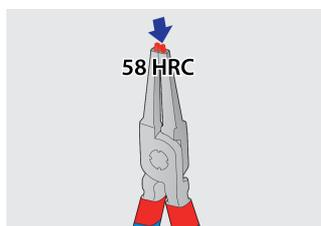
Les pointes durcies à 58 HRC ne subissent aucune déformation ni fracture lors du démontage ou de l'installation des circlips.
