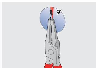
Die Spitzen werden in die Klemmbacke mit einem Winkel eingesteckt, der verhindert, dass der Sicherungsring von den Spitzen gleitet.
