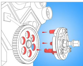
postavite krake izvlakača u otvore remenice
