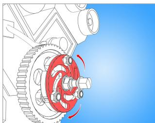
okretanjem ploče podešava se položaj kraka izvlakača, tako da se izvlakač može čvrsto postaviti na remenicu koja se skida
