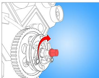
za pričvršćivanje izvlakača na remenicu okrećite vreteno u smeru kazaljke na satu dok se izvlakač ne pričvrsti
