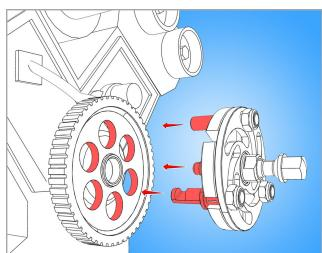
Postavite krake izvlakača u otvore remenice
