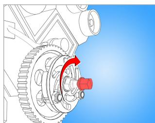
Za pričvršćivanje izvlakača na remenicu okrećite vreteno u smjeru kazaljke na satu dok se izvlakač ne pričvrsti
