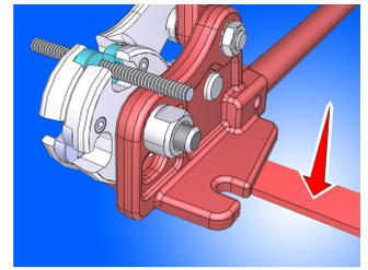
Ouverture des mâchoires ; pour opérer correctement, le coupe tiges filetés doit être ouvert au maximum en levant la poignée supérieure jusqu'à son point le plus haut. Ensuite, insérer la tige fileté dans la matrice correspondant à sa dimension.
