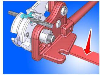
Das korrekte Öffnen der Schere; zur richtigen Verwendung des Werkzeugs muss die Schere bis zur maximalen Position des oberen Griffes geöffnet werden. Nachdem die Schere geöffnet ist, kann die Gewindestange in die dimensionsmäßig entsprechende Schneideöffnung eingesetzt werden.
