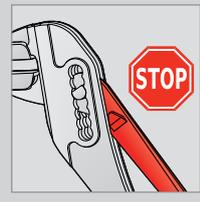
Die speziell geformten Griffe verhindern ein Einklemmen der Finger
