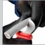
Messen Sie den Draht und schneiden Sie die gewünschte Länge ab.
