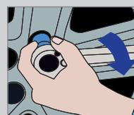
Setzen Sie den Drehmomentschlüssel an und beginnen Sie mit dem Festziehen (in die vorgeschriebene Drehrichtung). Beim akustischen Signal (Klick) ist das eingestellte Drehmoment erreicht. Das Festziehen ist damit beendet.
