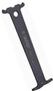
Messung: Von 0 bis 0,6% – Bereich, in dem die meisten Hersteller die Benutzung der Kette empfehlen. Von 0,7 bis 1,2% – Bereich, in dem die Hersteller das Auswechseln der Kette empfehlen. Empfehlungen des Herstellers berücksichtigen!
