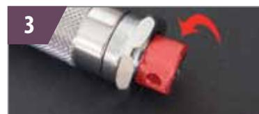
3 Vuelva a atornillar el perno inferior, para fijar el ajuste de torque.
