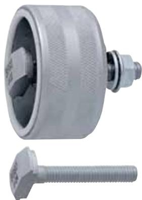
Esta herramienta se encuentra diseñada para extraer los rodamientos y las cazoletas del eje de pedalier del sistema del eje de pedalier BB90. Asimismo admite otros modelos con rodamientos press fit de 24 mm de eje, como por ejemplo BB86, BB92, SRAM Press Fit GXP. La herramienta extrae los rodamientos y las cazoletas del marco.
