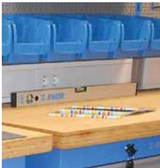
La superficie de trabajo de madera tiene 40 milímetros de espesor y está recubierta.
