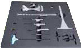
El juego incluye contiene varias herramientas específicas del cuadro, así como herramienta de calibrado del soporte de alineación.
