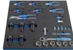
El juego incluye una selección específica de alicates para el servicio de suspensión, herramientas para el sello de la horquilla, extractor del buje, zócalos planos y otras herramientas.
