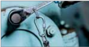
Verwendung von Ratschen: Ratschen für das Arbeiten in der Höhe haben im Gegensatz zu Standardratschen keine Auslösetasten für Einsätze.
