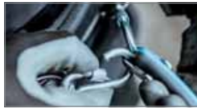
Der Karabiner am Anhängband wird in den Ring am Werkzeug eingeklinkt. Alle Ringe an den Werkzeugen sind ausreichend für zwei Karabiner.
