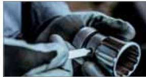
Mit dem Einsatzentferner (Art. 1111) den Stift in der Öffnung niederdrücken und dabei den Einsatz vom Ratschenvierkant abziehen. Neuen Einsatz oder Verlängerung aufsetzen.
