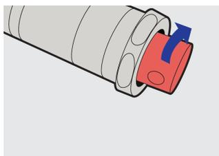
Riavvitare la parte inferiore del bullone, per fissare la regolazione della coppia.
