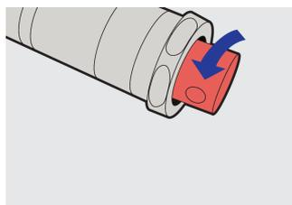
Svitare il bullone inferiore per rilasciare la vite per la regolazione della coppia di serraggio.
